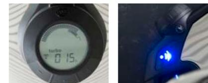
Si le Navigenio clignote en bleu et que le symbole radio apparaît sur l'écran de l'Audiotherm, cela signifie que l'Audiotherm et le Navigenio sont reliés par ondes radio. La température se régule automatiquement et le temps de cuisson est contrôlé.
